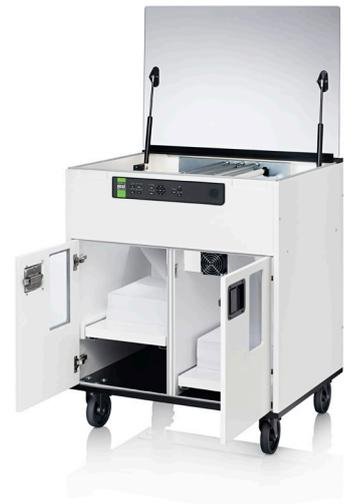
팬폴드-D V5는 입증 된 브레일박스 V5 기술 플랫폼을 기반으로 한 새로운 고속 점자프린터 입니다. 우수한 점자 품질, 고속, 낮은 유지 보수비용 및 가격경쟁력을 갖추고 있습니다. 팬폴드-D의 기본 구성은 간단합니다. 브레일박스의 점자출력 및 전자 모듈, 베이직-D의 용지 공급 기술, 인덱스 방음장치의 소음 감소 기술을 사용합니다. 이 간단한 원리를 조합하면 탁월한 결과를 얻을 수 있습니다. 팬폴드-D는 완성품으로 공급되며 쉽게 설치하여 사용할 수 있습니다.
